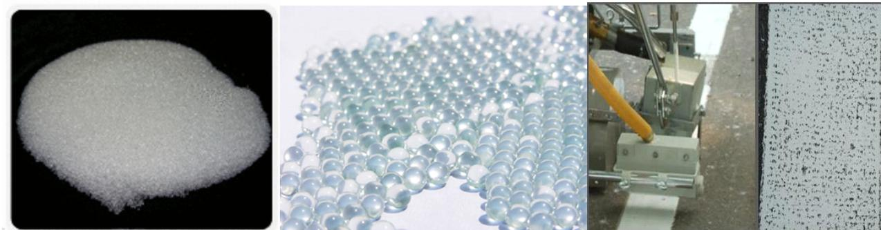
反光玻璃微珠是以玻璃砂为原料经高温熔融后而形成的一种细小的玻璃圆球颗粒。反光玻璃微珠作为道路标线（漆）中的反光材料，能改善路面标线涂料逆反射性能，提高夜间行车的安全性，已为各国交通管理部门予以确定。当汽车夜间行驶时，车灯照在带有玻璃微珠的道路标志线上，可使车灯的光线又平行反射回来，从而使司机看清前进方向，提高了夜间行车的安全性。现在，反光玻璃微珠已经成为了道路安全产品中不可代替的反光材料。
